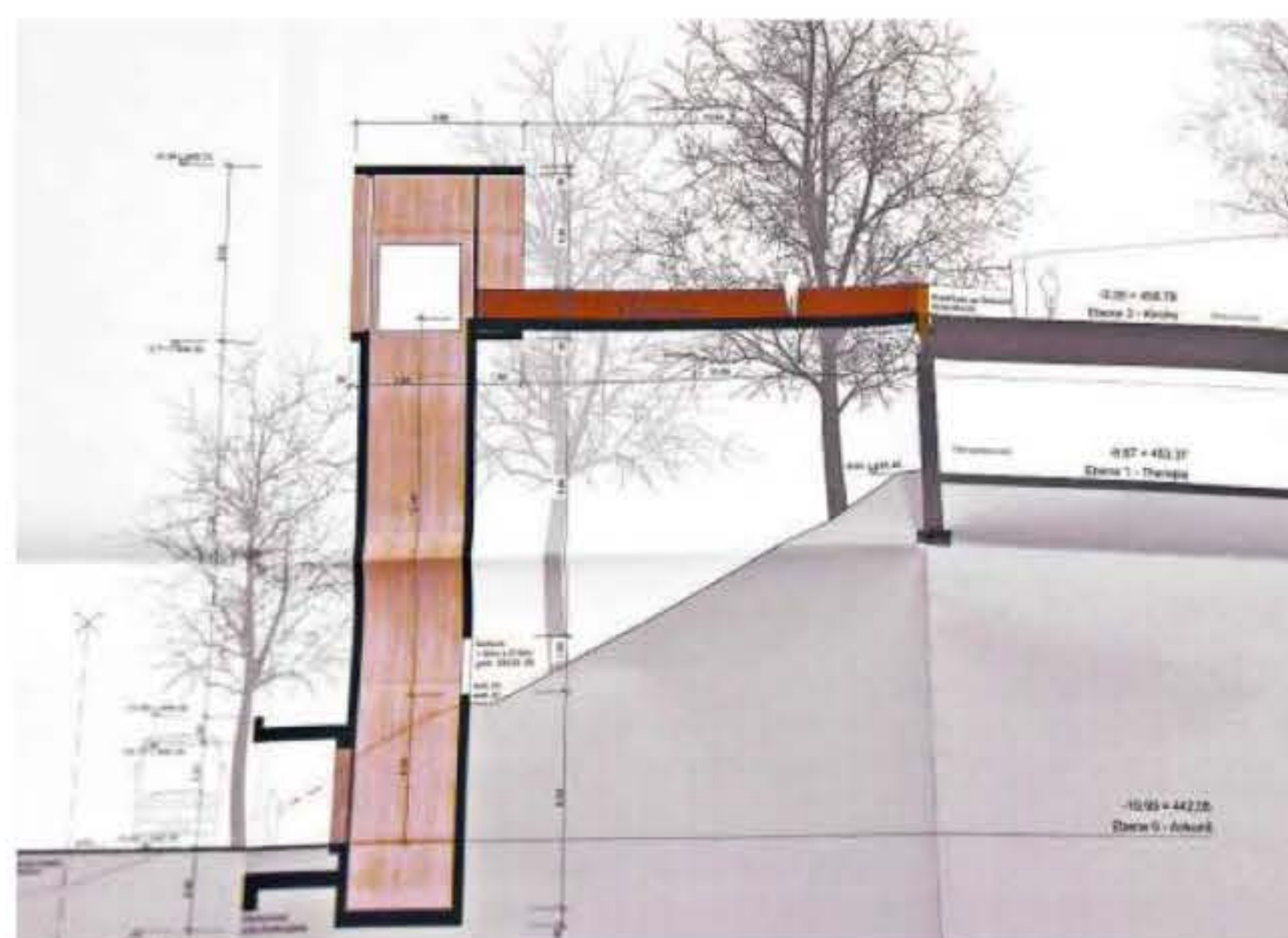
Der Liftturm als vertikales und der Steg als horizontales Element verbinden die Ankunftsebene mit dem Klosterhügel.
